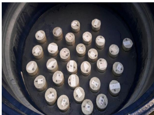
Figura 3: Imersão dos corpos de prova em solução salina.
