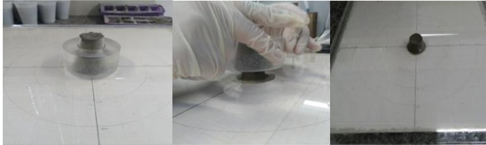
**Figura 7:** Execução do ensaio de mini-*slump*.
