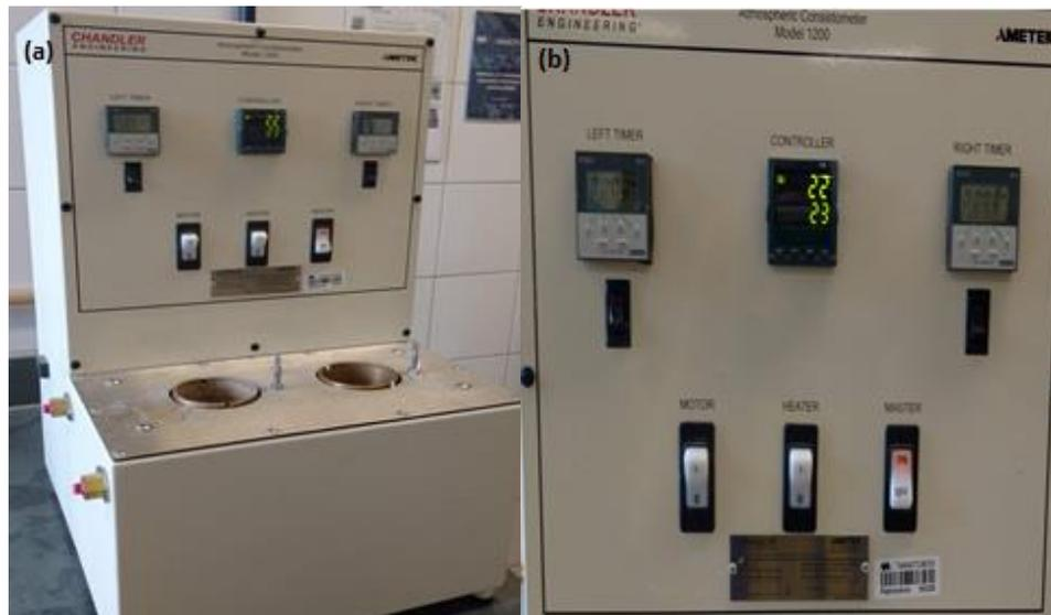
**Figura 6:** Consistômetro atmosférico utilizado na homogeneização das pastas: (a) Perfil do equipamento. (b) Painel de controle.
