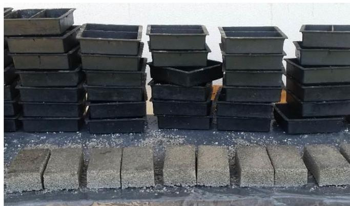
**Figura 3:** Tijolos de concreto após a desmoldagem.
