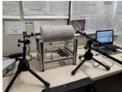
Figura 4: Equipamento Sonelastic e realização do ensaio de ressonância acústica.
