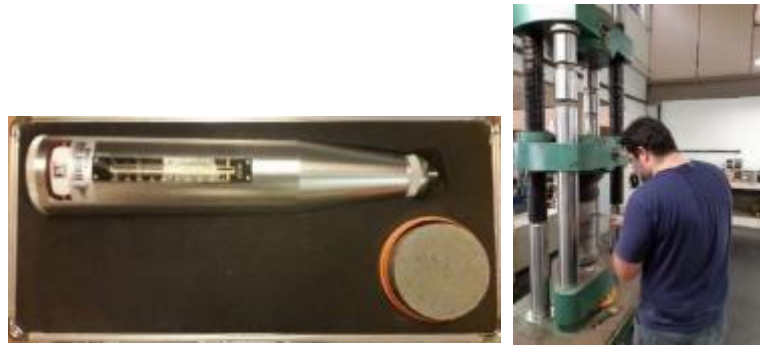
Figura 3: Esclerômetro e realização dos ensaios de esclerometria nos corpos de prova.
