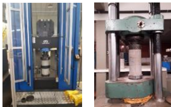
Figura 5: Ensaio de módulo de elasticidade tangente inicial e resistência à compressão.
