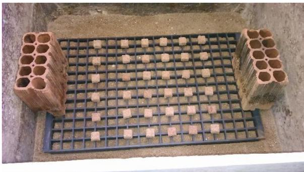
**Figura 2:** Arranjo dos corpos de prova no interior da caixa de fibro-cimento preparada para receber a colônia de *Nasutitermes* sp. Fonte: Os autores.
