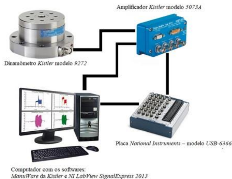
Figura 1: Modelo esquemático da obtenção das forças de usinagem – Etapa 1. Fonte: Adaptado de OLIVEIRA [13].
