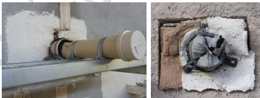
Figura 9: Aspecto final das faces do selo 03 após ensaio de desempenho
