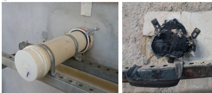
Figura 7: Aspecto final das faces do selo 01 após o ensaio de desempenho
