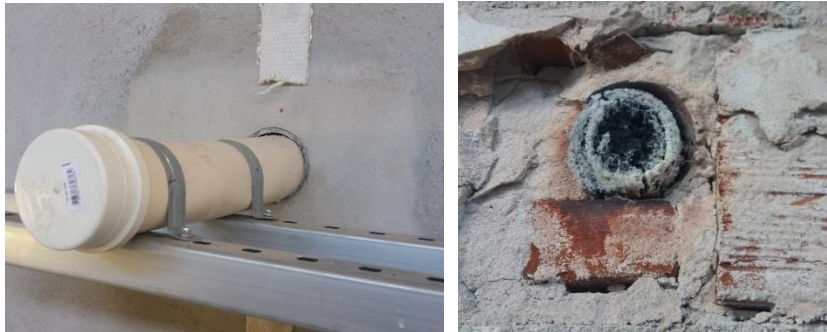
Figura 8: Aspecto final das faces do selo 02 após ensaio de desempenho
