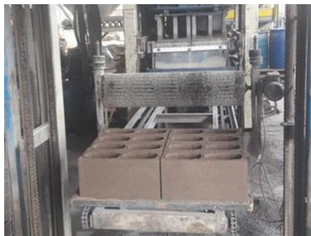
Figura 4: Desforma dos blocos após a sua produção em fábrica.
