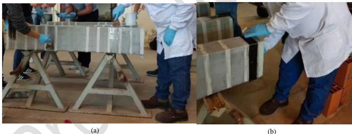
Figura 6: Aplicação da resina (a) e colocação da manta de fibra de carbono (b).
