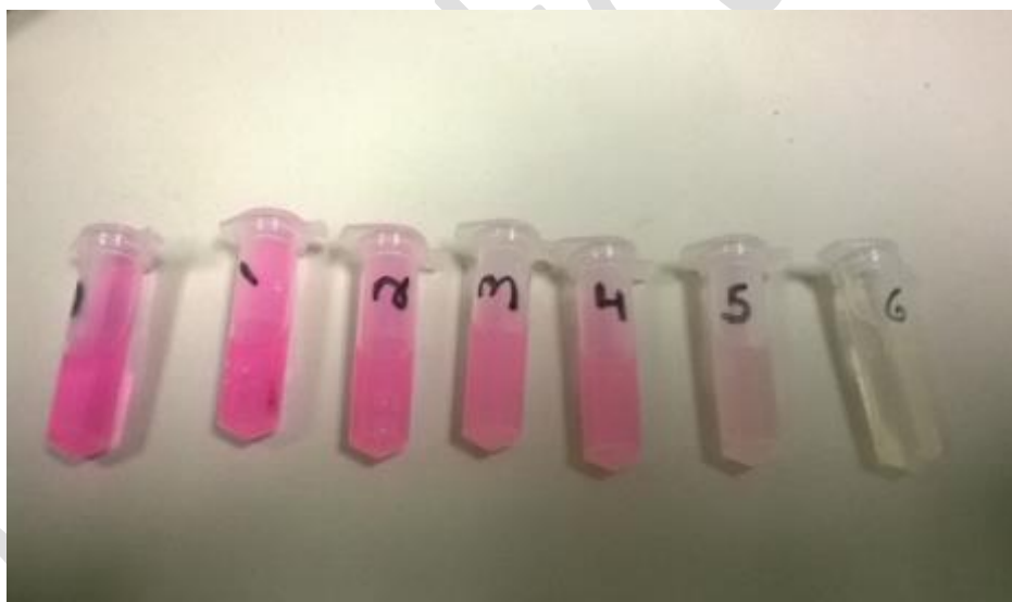
Figura 6: Evolução do descoramento da solução de rhB frente a irradiação ultravioleta da amostra Pn500.
