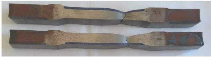
**Figura 8:** Imagem dos CPs de tração fraturados.
