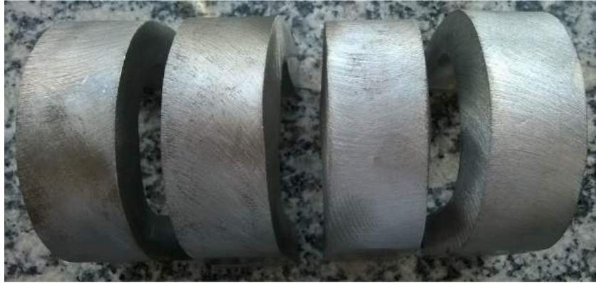
**Figura 9:** CPs após o ensaio de dobramento.
